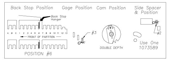
6. SOLD-OUT LEVER TO BE SHORT STYLE WITH FRONT SPACER. SPRING TO BE LOCATED ON THE RIGHT SIDE (LOW PRESSURE SETTING).
