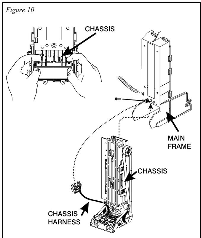
**DISASSEMBLING THE CHASSIS**
